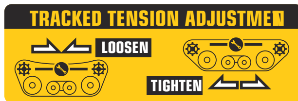
Figure 20 Réglage de la tension des chenilles :
