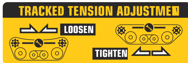
Figuur 20 Instelling van de rupsbandenspanning: Loosen = Ontspannen Tighten = Spannen
